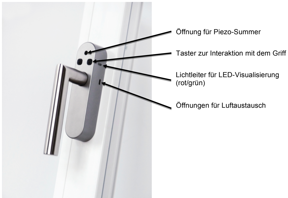
Abb. 4 Fenstergriff der Firma SODA und Beschreibung des Nutzerinterfaces
