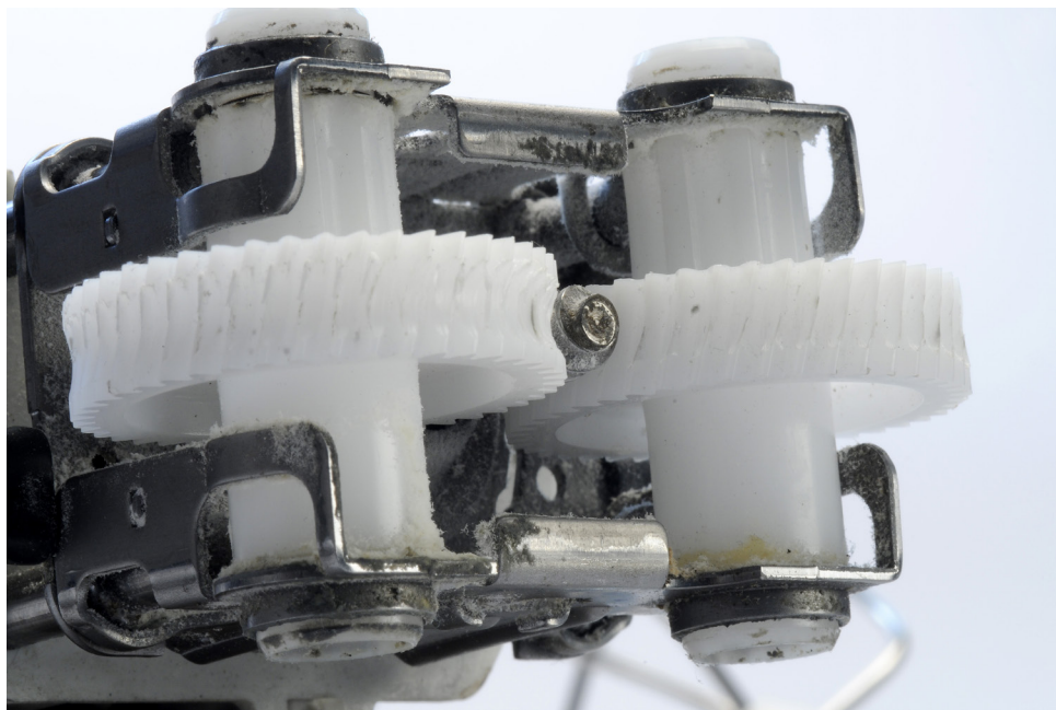
Schwachstellen im Handmixer: Zahnräder mit erhöhter Verschleißanfälligkeit werden nicht tauschbar montiert.
